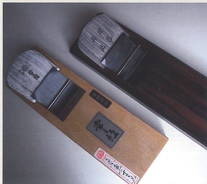
Twee schaven met prachtige schaafbeitels van Harima. De schaven zelf zijn gemaakt door Toshinobu Horiba : links in wit eiken, rechts in palissander, afmetingen 28,5 x 9 cm met schaafbeitels van 70 mm breed.
