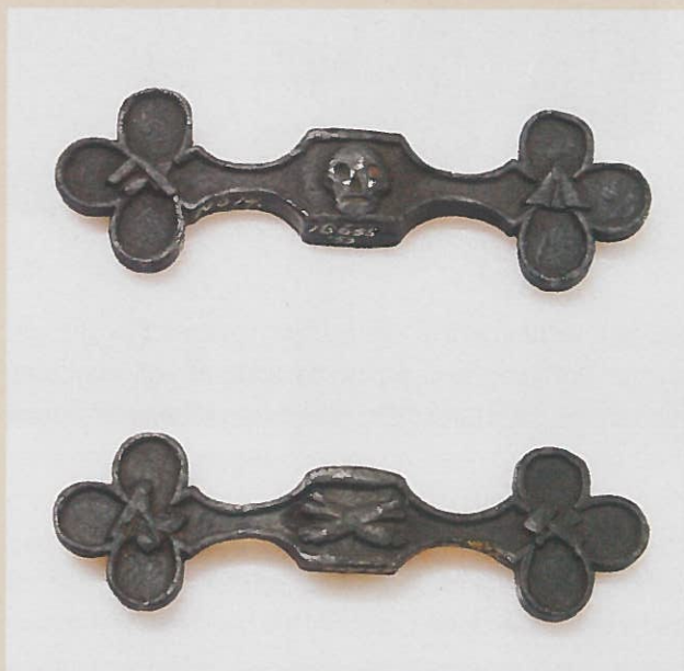
Gietvormen voor een pareerstang (onderdeel van een zwaard of ponjaard) uit de Mansvelt-fabriek.
