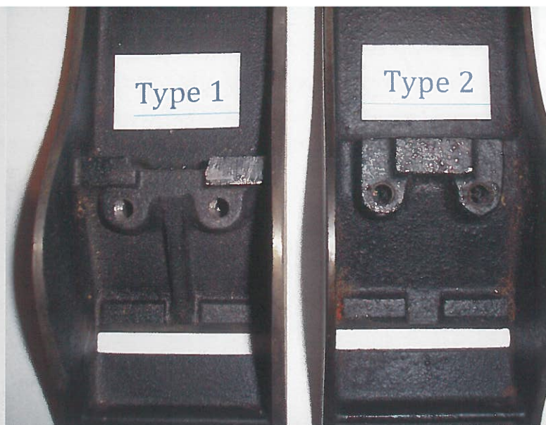
De verschillen in het gietstuk van de typen 1 en 2.
