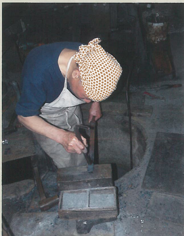
De harde snijkant wordt aangebracht. Op de voorgrond het kistje met poeder dat eerst op het hete ijzer wordt gestrooid.
