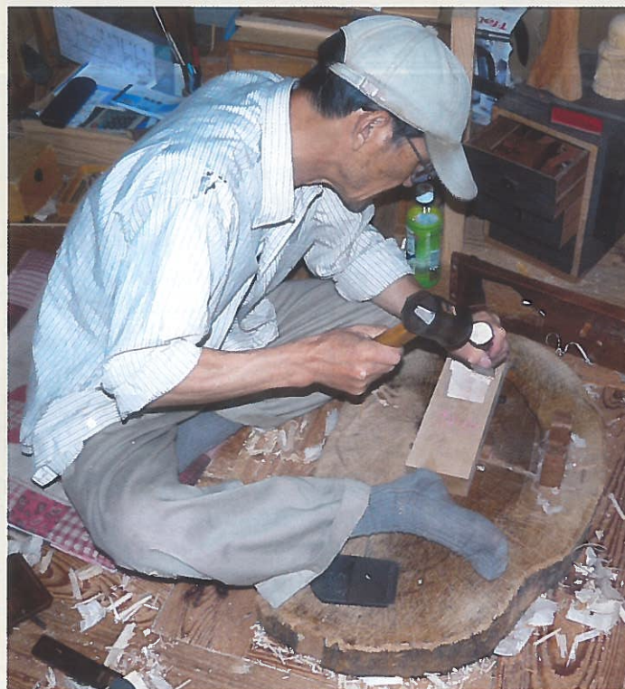
Toshinobu Horiba maakt het bed voor de schaafbeitel op maat.
