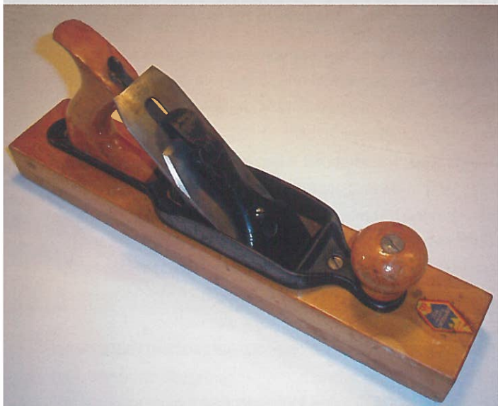
Voorloper met houten bodem.
