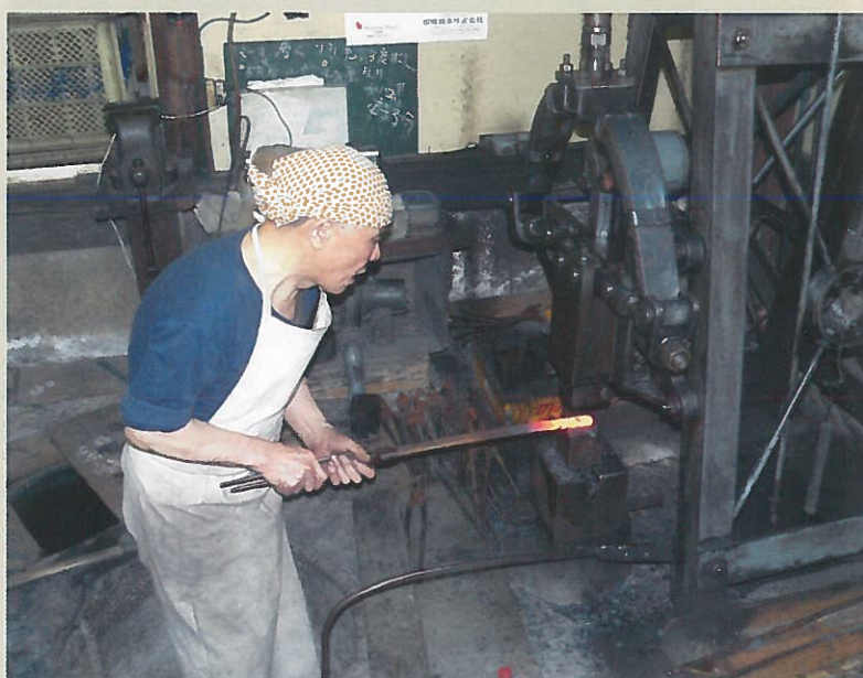
Het smeedwerk wordt voltooid onder de mechanische hamer. Vervolgens wordt de beitel afgekort.
