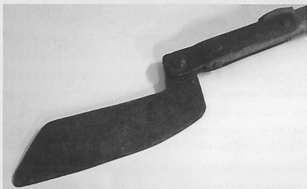
3. De bijl van foto 2 met het blad 180 graden omgeklapt zoals bij een hakslag.
