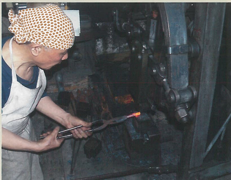
Het smeden van de 'socket' en de arend.
